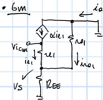
$$\bullet V_S = V_{icm} \cdot \frac{R_{EE} // \alpha_{oi}}{\alpha_{oi} + R_{EE} // \alpha_{oi}}$$
