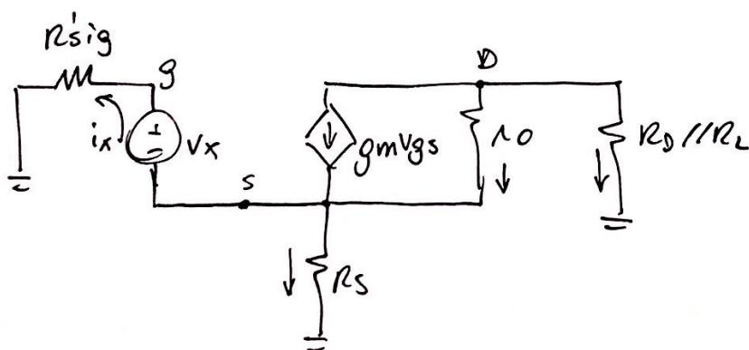
$$\rightarrow Nô'S: i_x + \frac{V_s}{R_s} = g_m v_{gs} + \frac{V_D - V_s}{R_O} \quad | \quad v_{gs} = V_x$$
